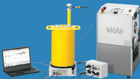
Apparecchio di prova e diagnostica VLF viola ↑
