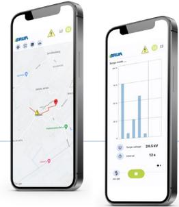
In questo modo l'utilizzatore ha la possibilità di attivare l'alta tensione solo dopo aver raggiunto il punto di guasto prelocalizzato. Dopo aver localizzato il guasto, l'alta tensione può essere disattivata. In questo modo, la sollecitazione sul cavo e sul sistema si riduce al minimo e la sicurezza aumenta notevolmente.
