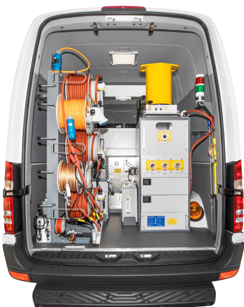
Przykład PD-TaD w kablowym samochodzie pomiarowym
