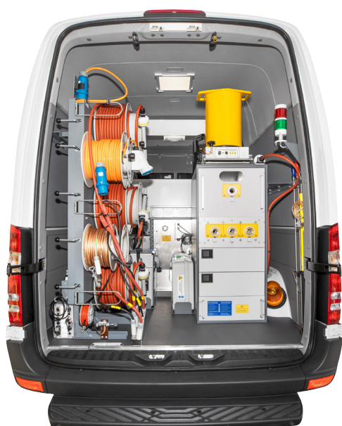
Příklad systému PD-TaD v kabelovém měřicím vozu
