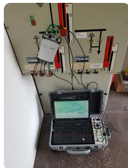
Collegamento sotto tensione, misura sotto tensione: con il VDS-C è possibile riconoscere in modo rapido e facile scariche parziali su cavi durante il funzionamento.
