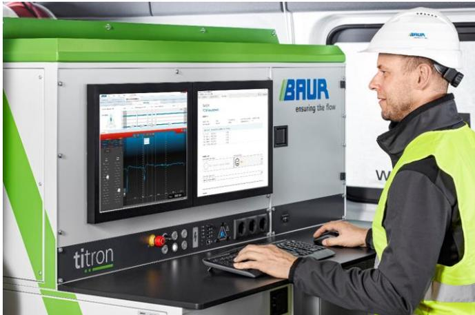
Graças aos processos paralelizados – como a combinação da medição de fator de dissipação e de descarga parcial em uma operação – as funções de medição são realizadas mais rapidamente. Assim os técnicos de medição registram consideravelmente mais informações em seu tempo de trabalho e geram um benefício adicional para a gestão de ativos e de manutenção. Para tirar o máximo proveito das informações, além dos
