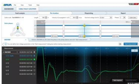
Il supporto fornito dalla Smart Cable Fault Location Guide accelera e semplifica la prelocalizzazione e la localizzazione precisa dei guasti nei cavi. Inoltre, il software può essere collegato alla banca dati dei cavi BAUR e ad un sistema informativo geografico, per poter circoscrivere il tipo e il punto di guasto in modo ancora più rapido. Anche durante la localizzazione precisa il software BAUR offre supporto e protegge addirittura il cavo: L'app
