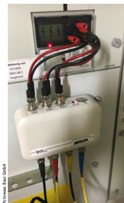
Рис. 1. Подключение прибора для измерения частичных разрядов к разъемам VDS распределительного устройства ветроэнергетической установки
