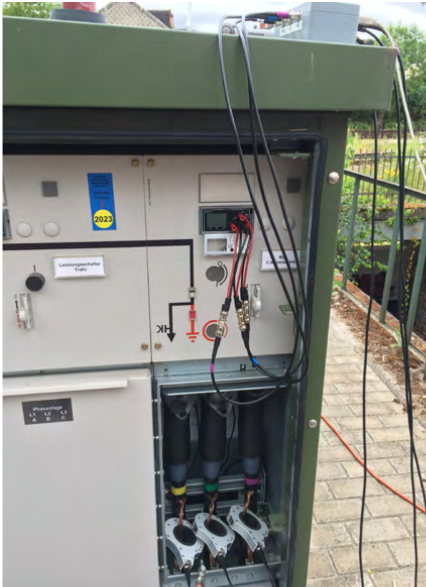
Imagen 3. Para comparar la calidad de medición, el medidor de descargas parciales lioni se conectó tanto con el nuevo acoplamiento DP VDS (arriba) como con los sensores HFCT (abajo).
