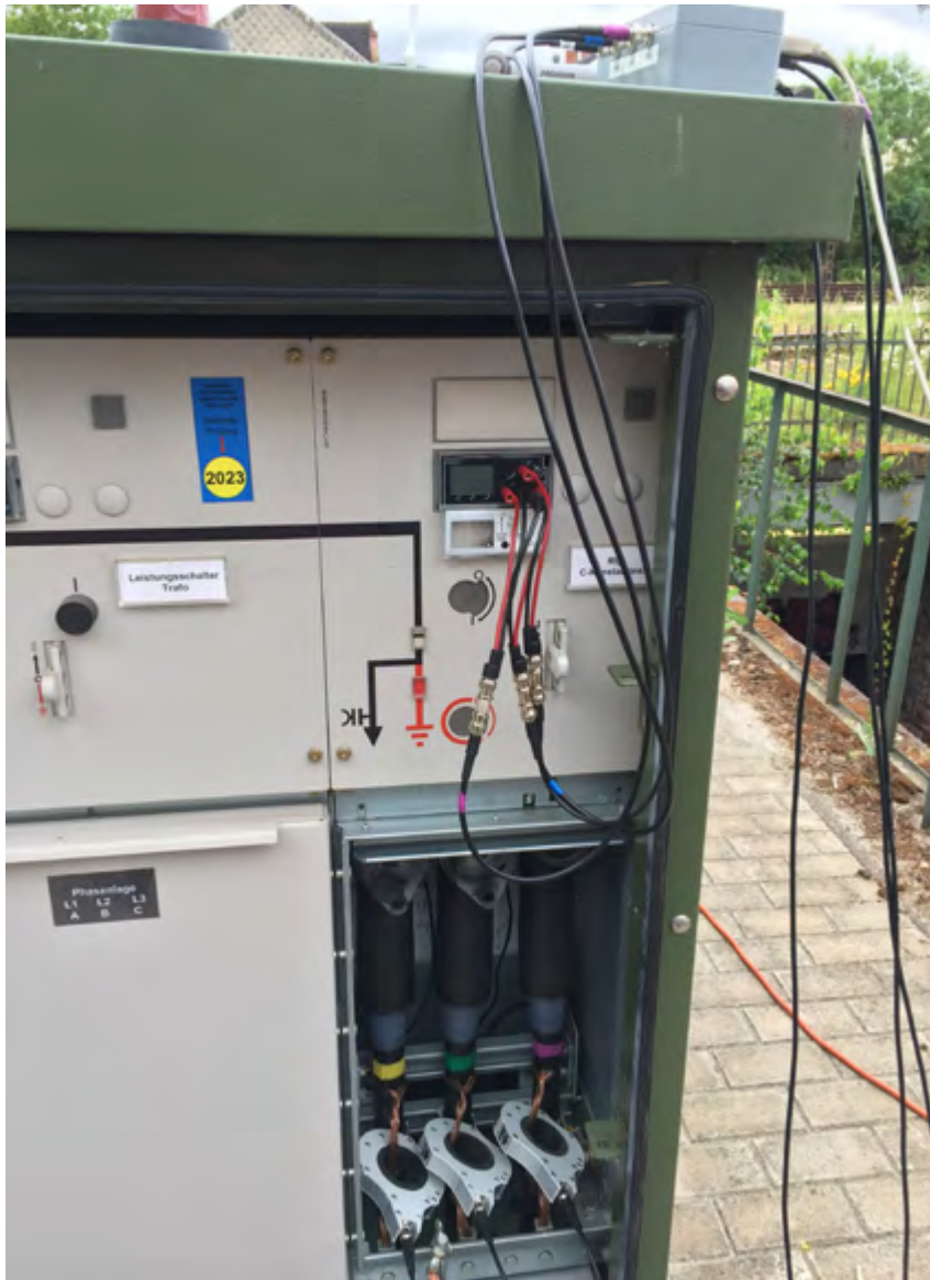
图 3. 为了对比测量质量，将局部放电测量仪 liona 与新型 VDS 局部放电耦合器（上）以及 HFCT 传感器（下）相连。
