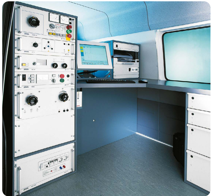
↑ Sistema trans cable, monofásico
