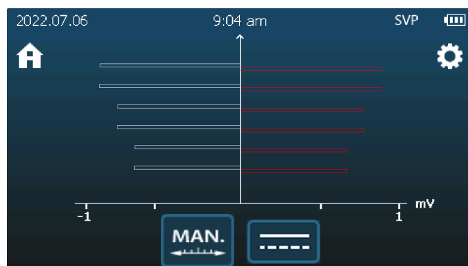
Определение мест повреждения кабельной оболочки с помощью импульсного постоянного напряжения
