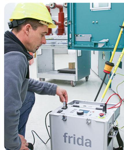
O teste de revestimento e de cabos lhe auxilia na avaliação, se um sistema de cabos está seguro para a operação e pronto para a utilização no instante do teste. Cada vez mais operadores de rede fazem uso do diagnóstico de cabos, uma vez que ele fornece indicações importantes sobre deficiências ocultas nas instalações e, em especial, na rede de cabos.
