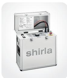
01 / Equipamento para teste de revestimento de cabos e localização de falha em cabo shirla
