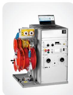
↑ 03 / Sistema de localização de falha em cabo Syscompact 2000 M pro
