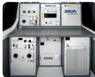
↑ 04 / Veículo para teste de cabos transcable
