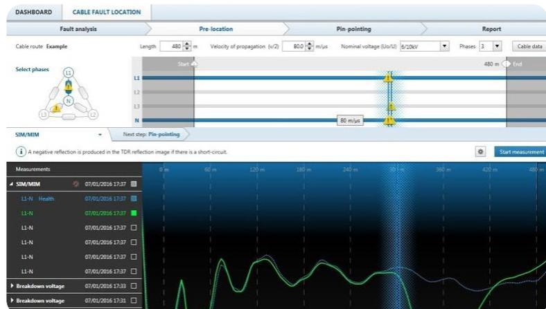
→ O display do Software 4 da BAUR permite uma visualização abrangente de todos os ajustes importantes, parâmetros de localização de falhas e dos dados do cabo. A parte inferior do monitor exibe os resultados da medição e permite um protocolamento imediato de resultados importantes.
