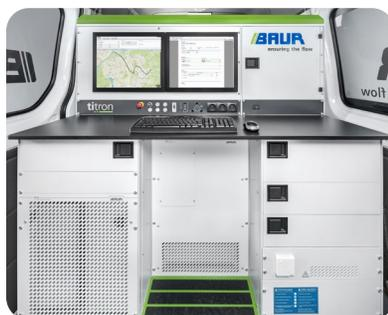
↑ 04 / Veículo para teste de cabos titron®
